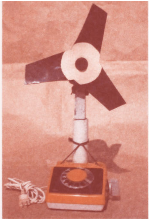
Ventilateur réparé avec un cadran de téléphone.
